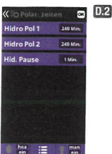
D.2 Einstellung der Polaritätszeiten. Bei Hoher Alkalität sollten die Zeiten in Hydro Pol 1 + 2 reduziert werden.
